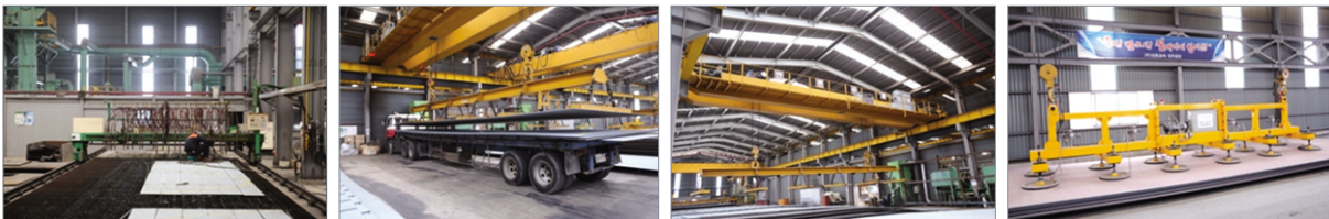
CNC 철판절단장비 (3기) O.H 크레인 (23기 / 마그네트 10기) 철판 AIR흡착기 (LNG TANK 전용)
